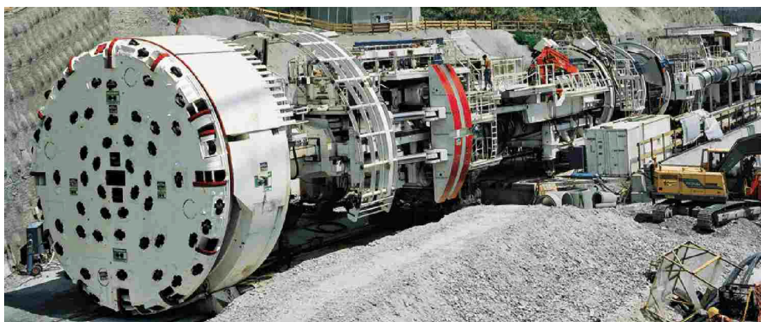
Figura 5 TBM de Rocha Dura
